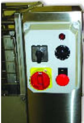
Réglage de la température de chauffe des lames
