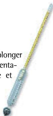
Pour la préparation de l'hydromel. Mesure la densité, le poids du miel contenu et l'alcool à produire.
